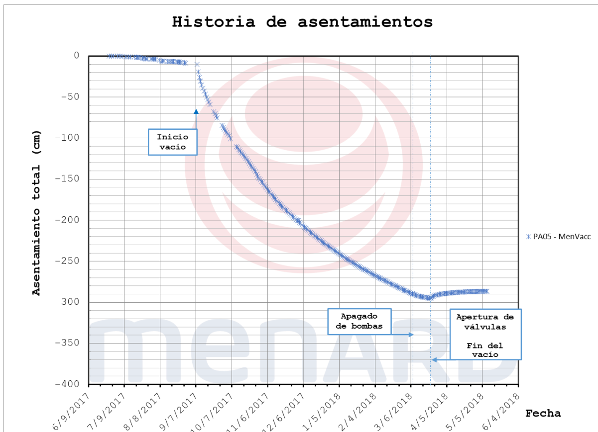
Figura 6. "Resultados de asentamientos de la placa de asentamiento central (PA05) en el panel de prueba de consolidación por vacío con membrana MENARD VACUUM"
