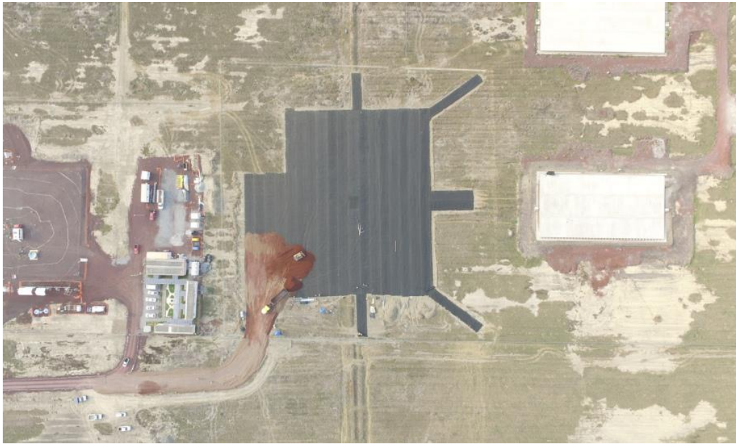
Figura A.1. "Panel de prueba de consolidación acelerada con vacío con membrana - Menard Vacuum - Conformación de plataforma de trabajo preliminar e instalación de instrumentación."
