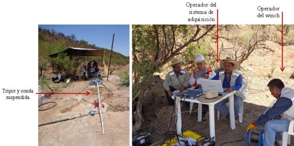
Figura 5.e.16. Sonda suspendida operando
