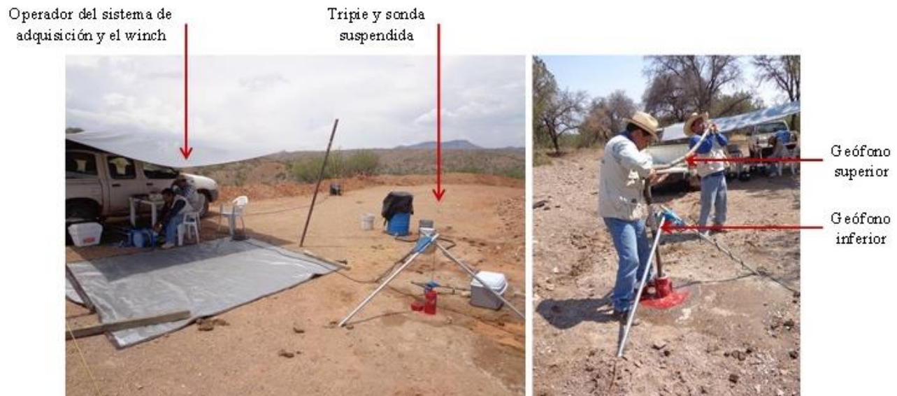
Figura 5.e.14. Colocación de la sonda suspendida en el pozo
