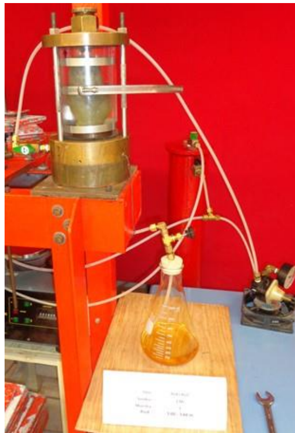
Figura 5.d.10. Probeta de suelo en la etapa de extracción de agua intersticial.
