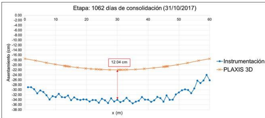
Fig. 4.1.9.62. Asentamiento a los 1062 días del final del proceso constructivo
