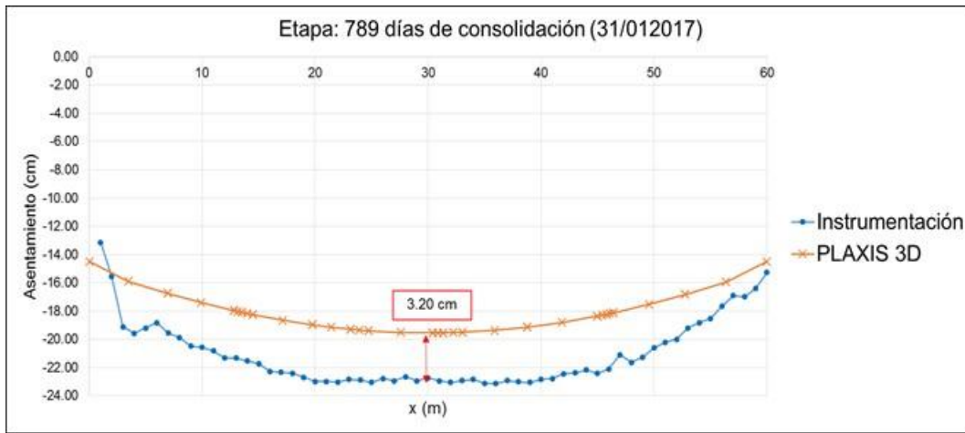
Fig. 4.1.9.57. Asentamiento a los 789 días del final del proceso constructivo
