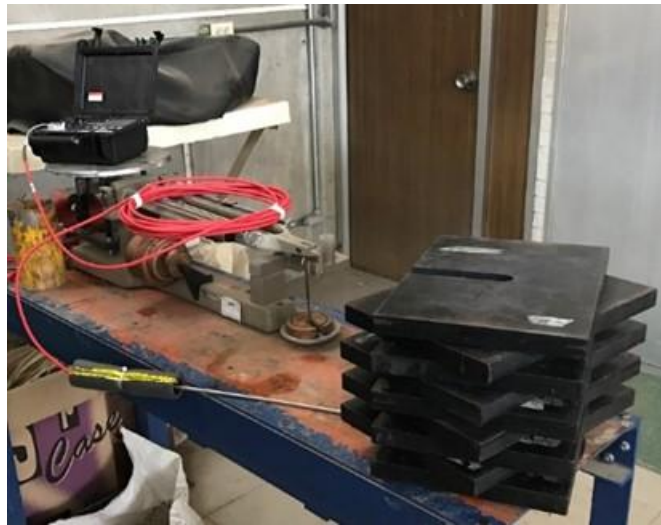
Fig. 4.1.11.1. Verificación de celdas de presión con arena y pesos muertos.
