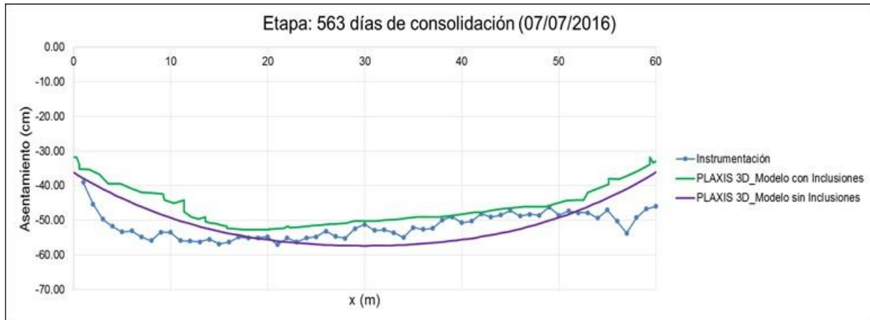
Fig. 4.1.10.58. Asentamiento a los 563 días del término de la construcción
