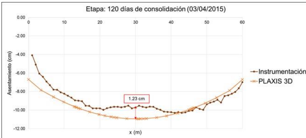
Fig. 4.1.9.43. Asentamiento a los 120 días del final del proceso constructivo
