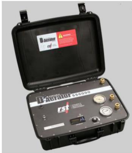
Figura 4. Unidad de Desaeración del Sistema de Monitoreo Automatizado de Asentamiento
