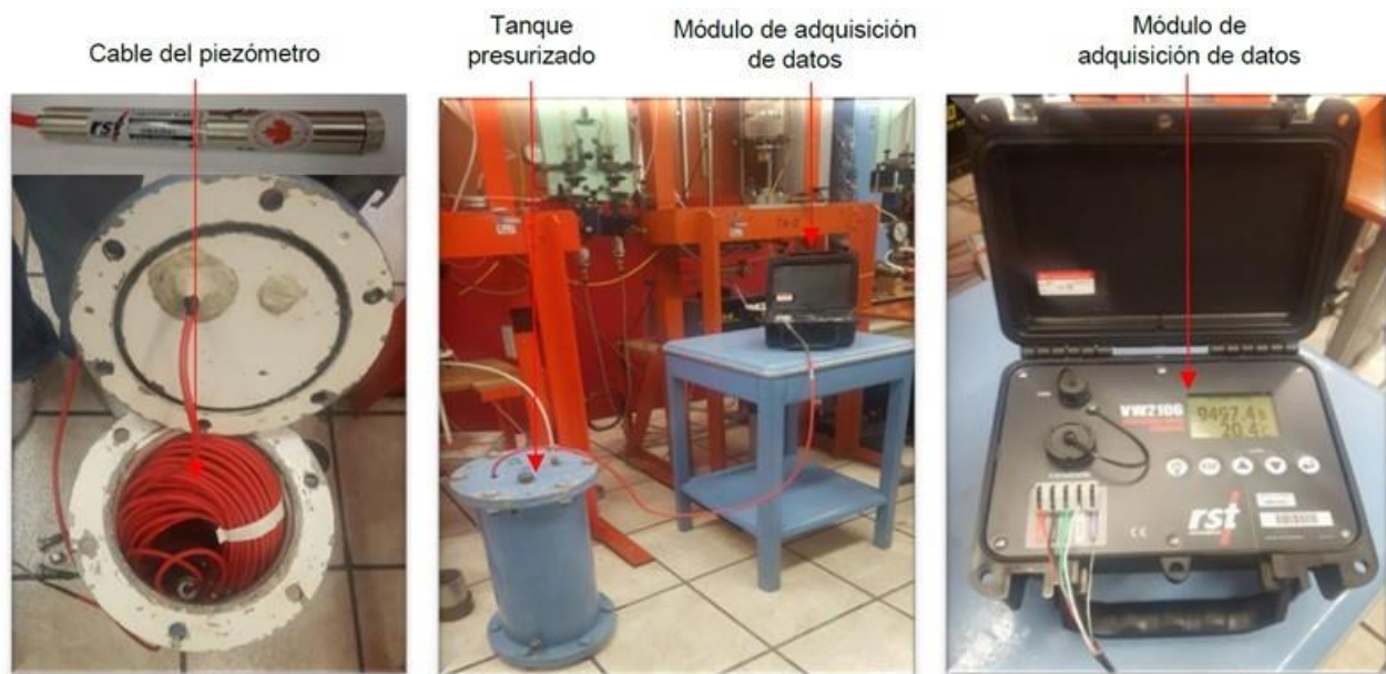
Figura 1. Sistema para verificar los piezómetros de cuerda vibrante.
