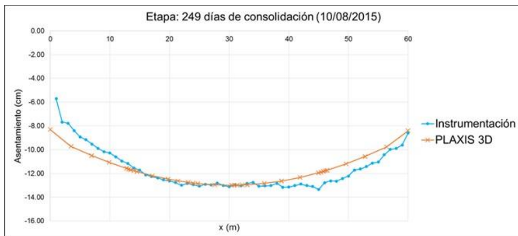
Fig. 4.1.9.47. Asentamiento a los 249 días del final del proceso constructivo
