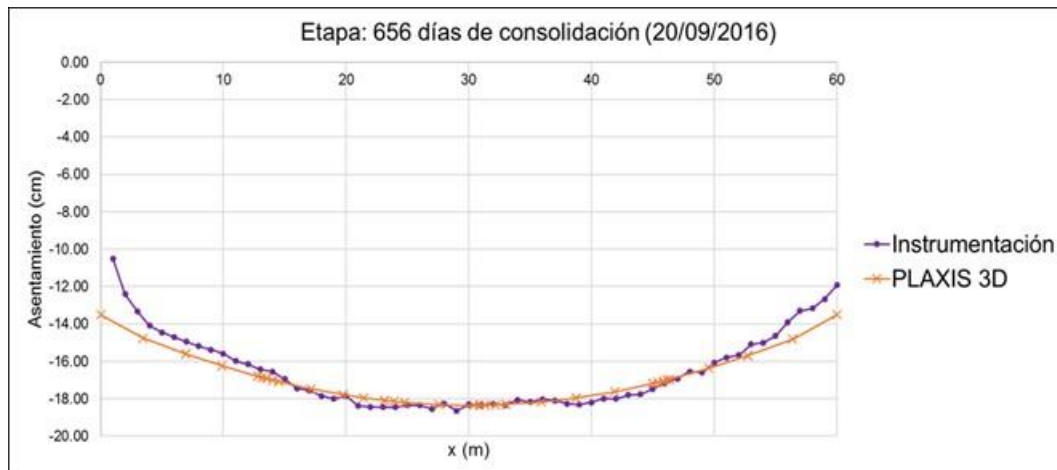
Fig. 4.1.9.55. Asentamiento a los 656 días del final del proceso constructivo
