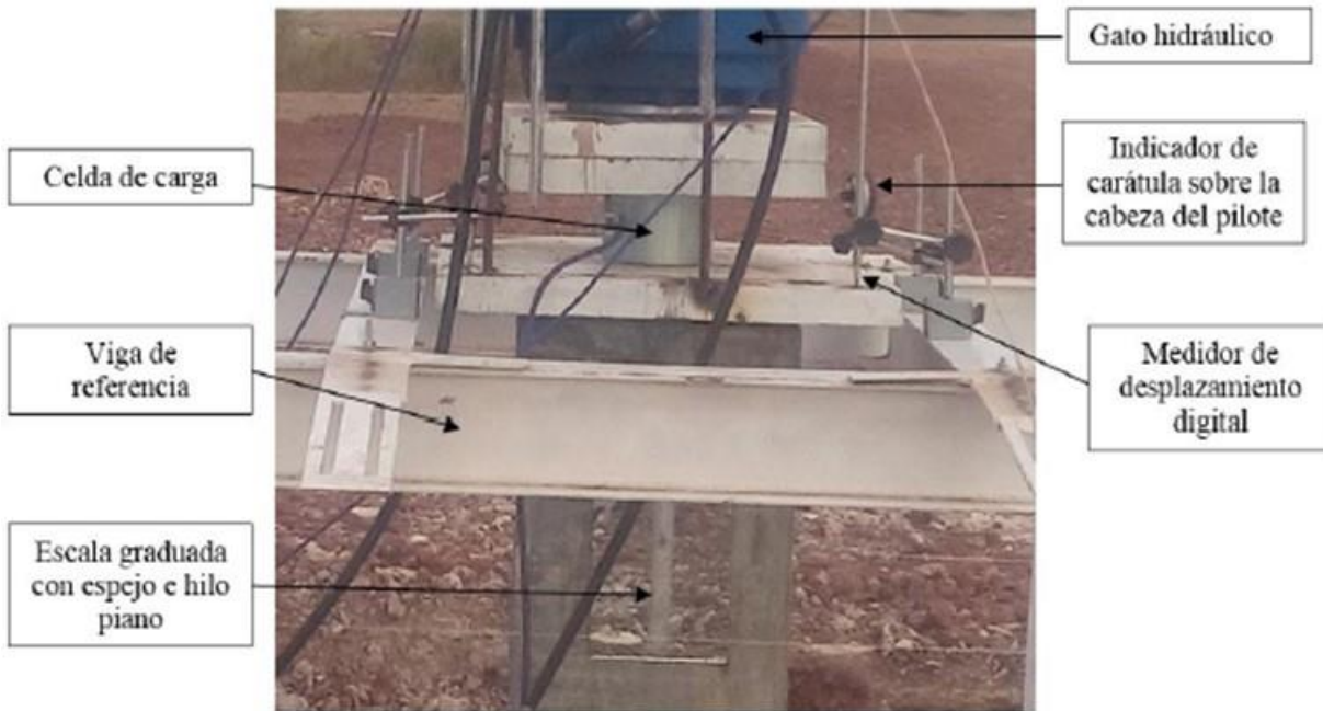
Figura C2. Instrumentación en la cabeza del pilote
