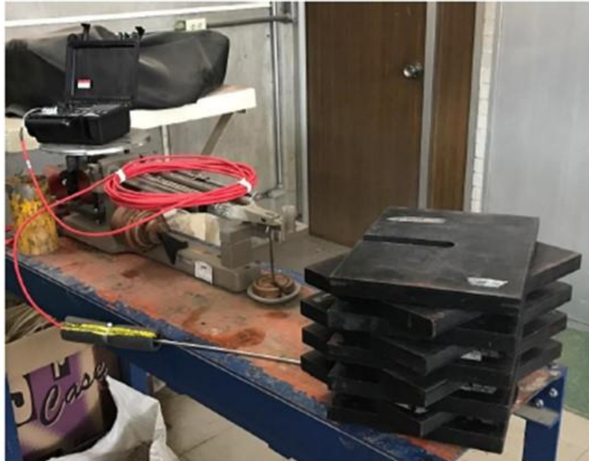
Figura A3. Verificación mediante peso muerto
