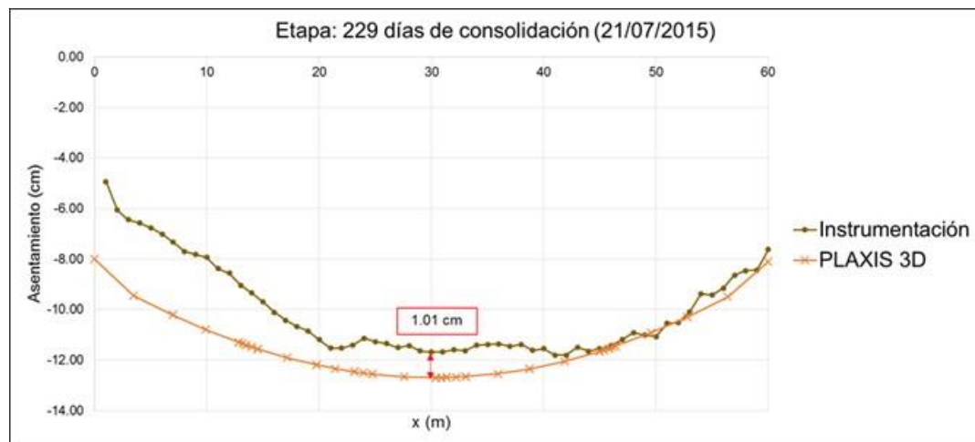
Fig. 4.1.9.46. Asentamiento a los 229 días del final del proceso constructivo
