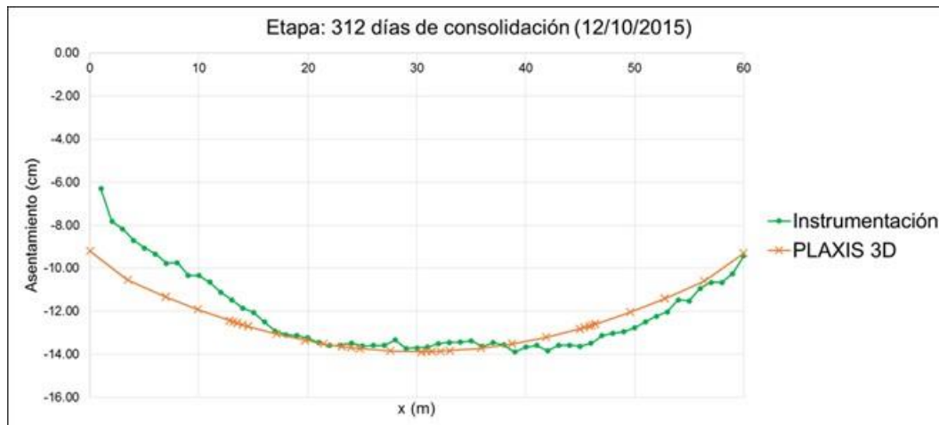
Fig. 4.1.9.49. Asentamiento a los 312 días del final del proceso constructivo
