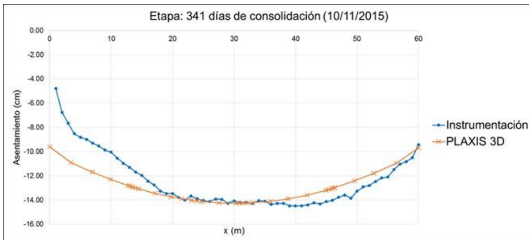
Fig. 4.1.9.50. Asentamiento a los 341 días del final del proceso constructivo
