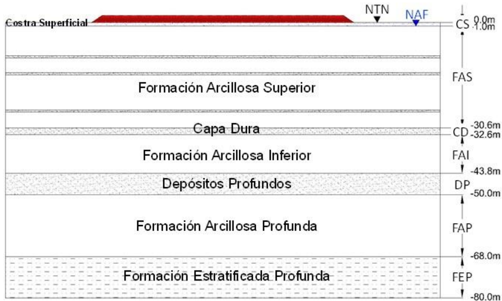
Fig. 4.1.2.4 Caracterización estratigráfica del sitio de la prueba la plataforma tratada con drenes verticales con sistema de vacío
