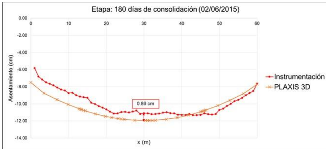
Fig. 4.1.9.45. Asentamiento a los 180 días del final del proceso constructivo
