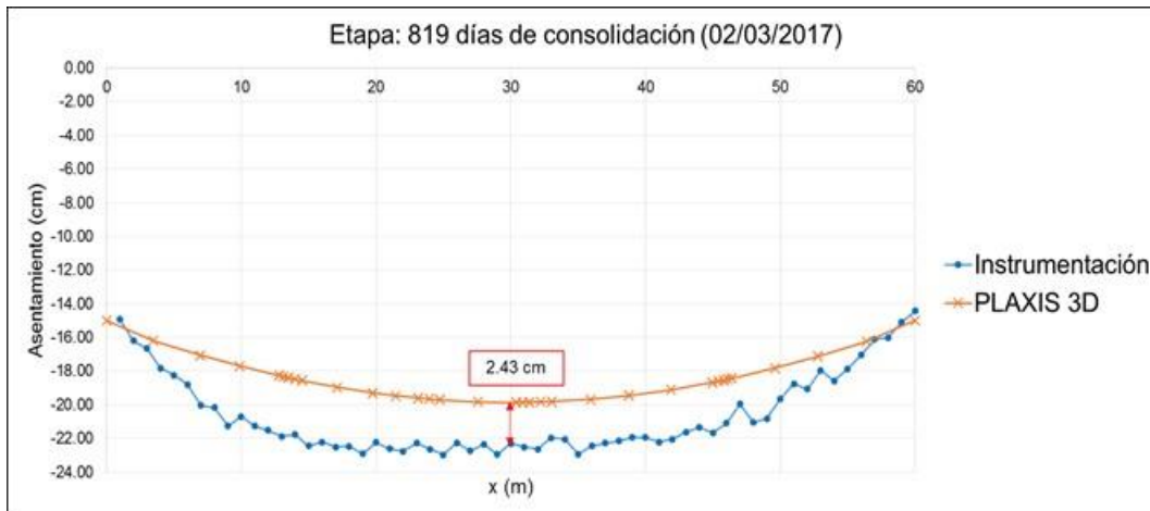
Fig. 4.1.9.58. Asentamiento a los 819 días del final del proceso constructivo
