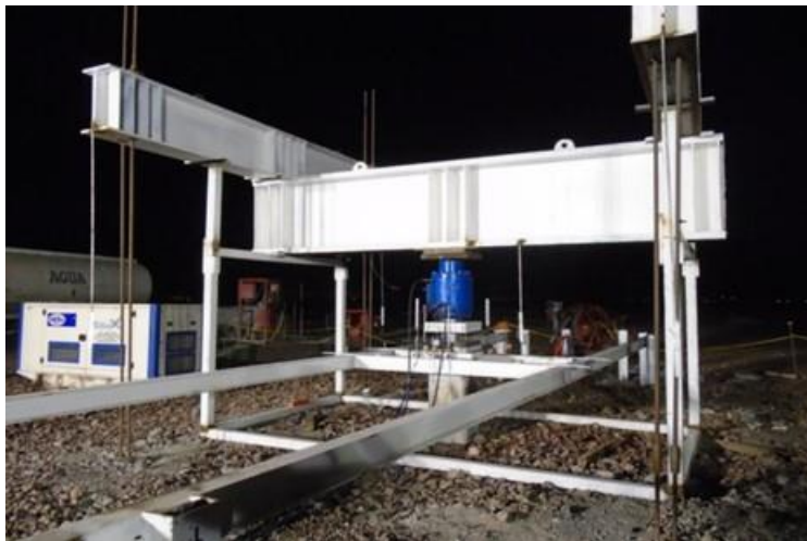
Figura A1. Vista general del sistema de reacción
