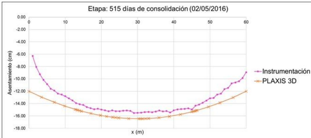
Fig. 4.1.9.52. Asentamiento a los 515 días del final del proceso constructivo
