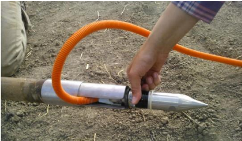
Figura 7. Piezómetro antes de su instalación
