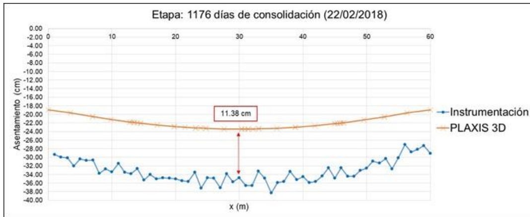
Fig. 4.1.9.63. Asentamiento a los 1176 días del final del proceso constructivo
