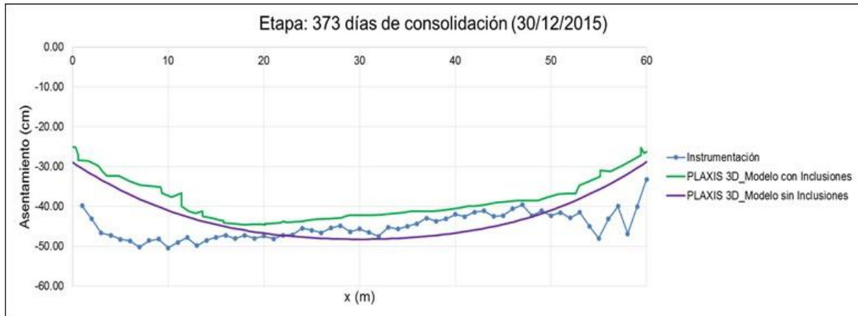
Fig. 4.1.10.55. Asentamiento a los 373 días del término de la construcción
