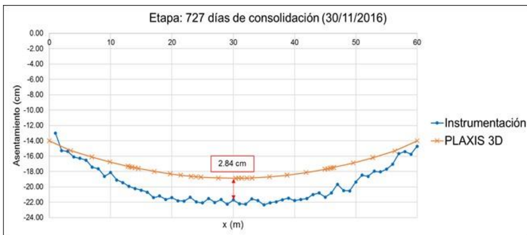
Fig. 4.1.9.56. Asentamiento a los 727 días del final del proceso constructivo
