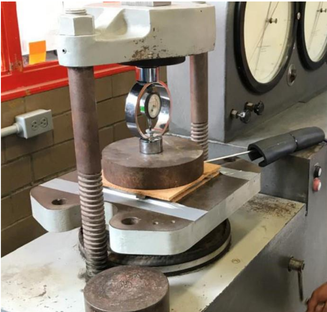
Figura 1. Arreglo para verificar las celdas de presión.
