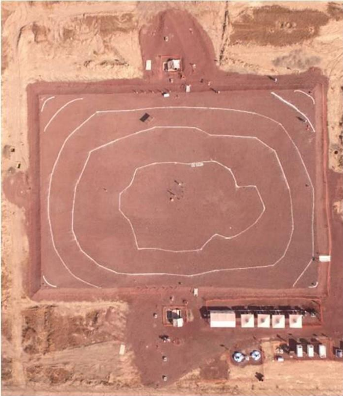
Figura 1. Vista aérea de la plataforma bajo vacío dren a dren, un mes después de apagar el sistema
