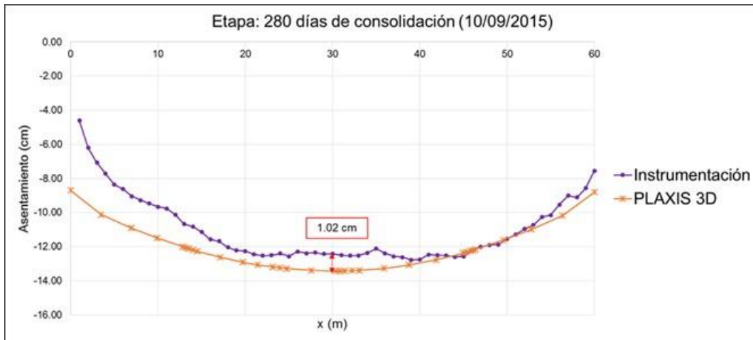
Fig. 4.1.9.48. Asentamiento a los 280 días del final del proceso constructivo
