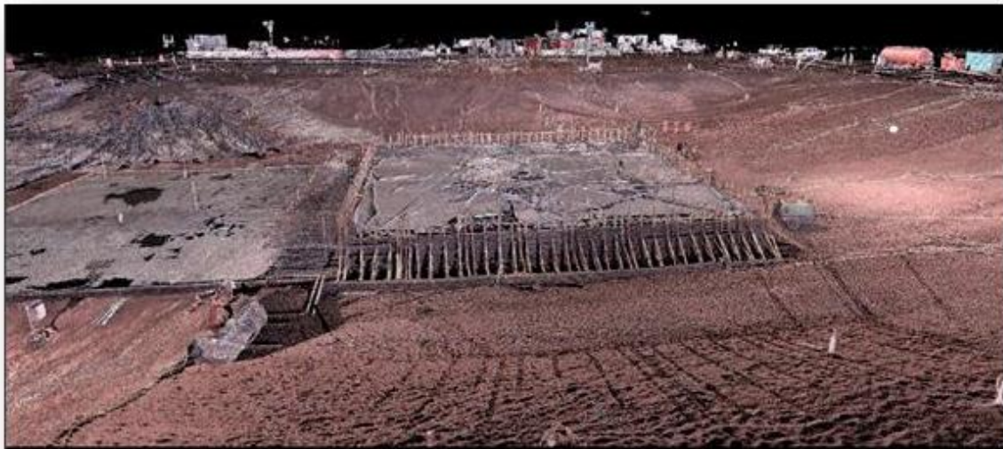
Clasificación de la nube de puntos obtenida con escáner láser digital terrestre 3D
