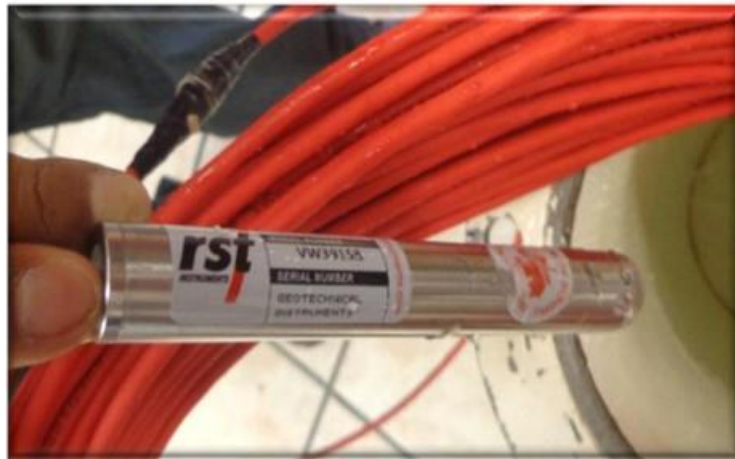
a) Piezómetro a verificar
