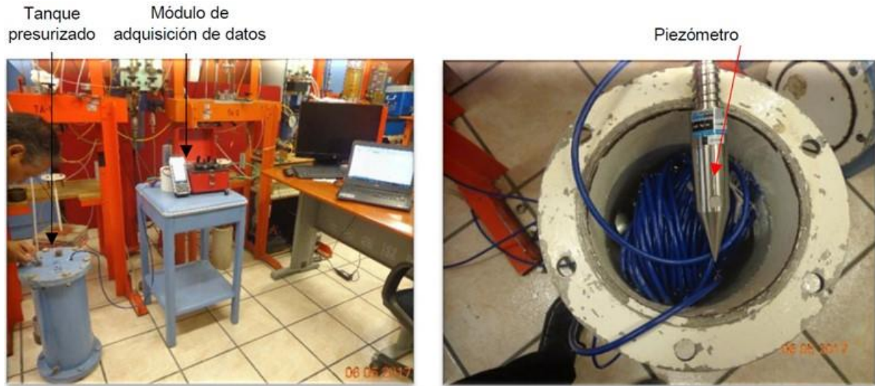
Figura 1. Tanque presurizado con piezómetro a calibrar
