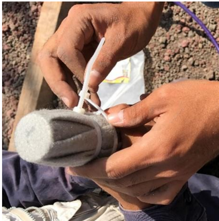
Fig. 4.4.7.3 Protección para la piedra porosa del piezómetro.
