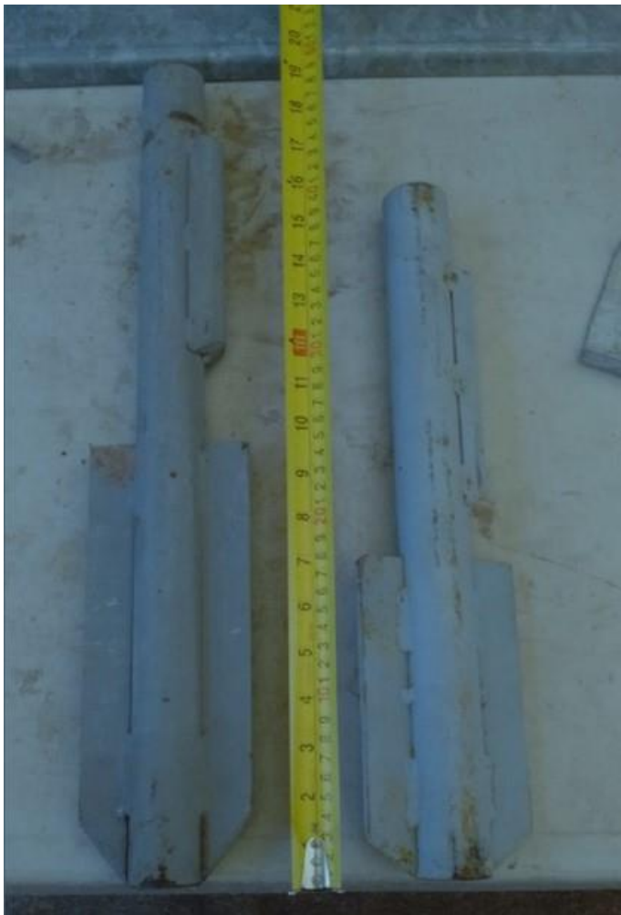
Figura 11 Aditamento para colocar el piezómetro push in a cierta profundidad
