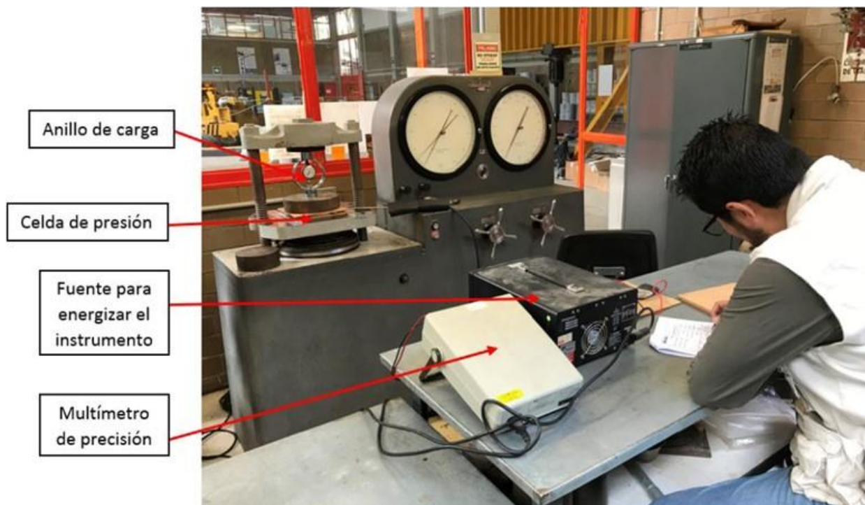
Figura 3. Equipo usado en la verificación de las celdas.
