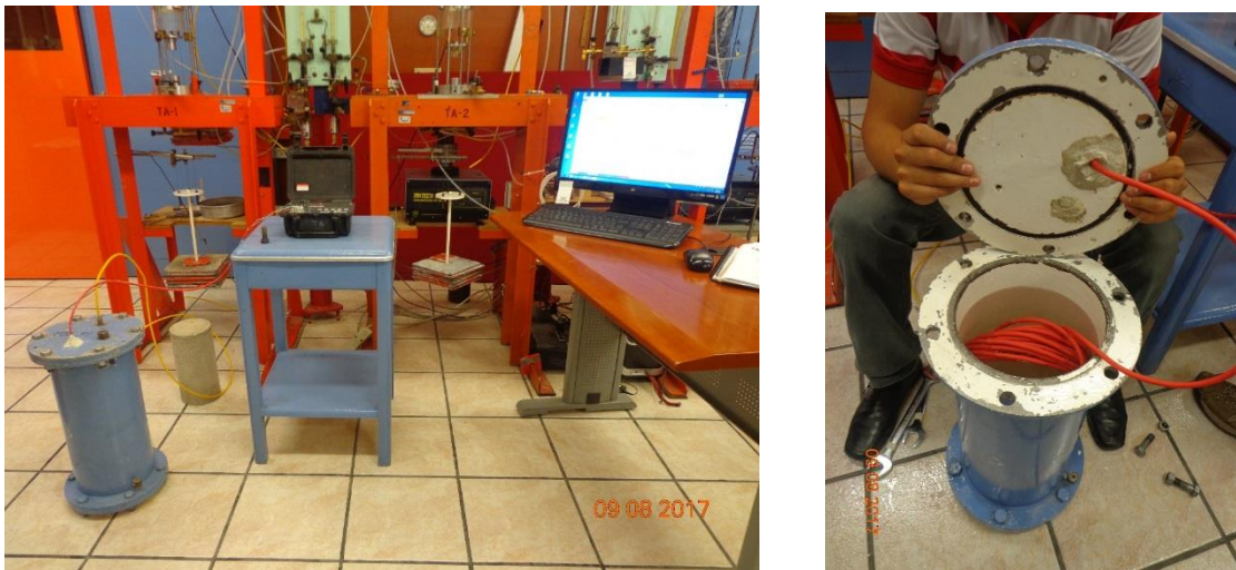
Fig. 4.1.11.5. Verificación de piezómetros eléctricos.
