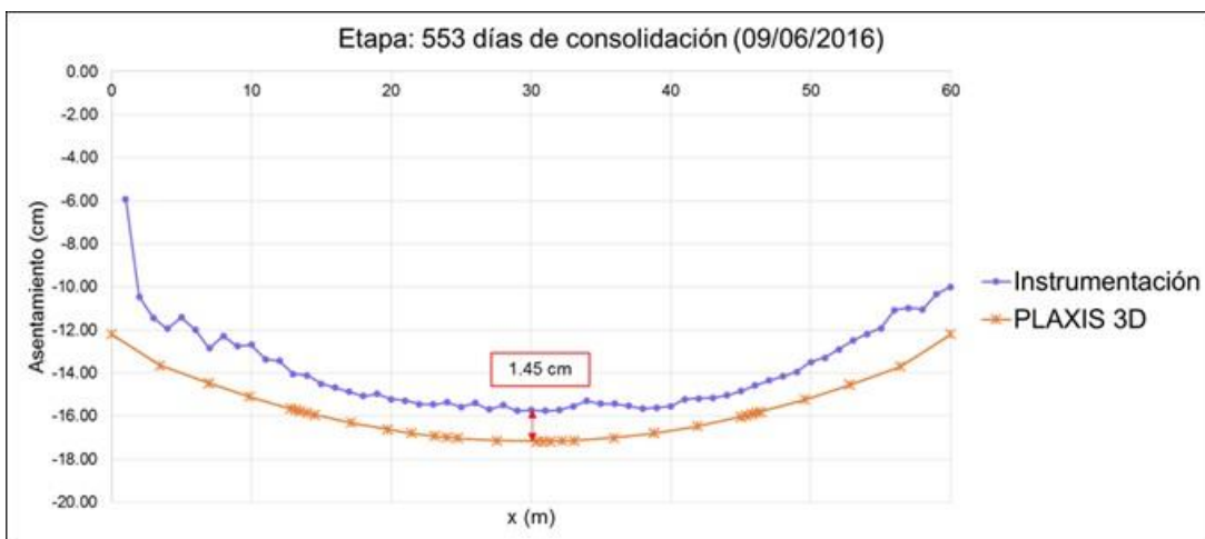
Fig. 4.1.9.53. Asentamiento a los 553 días del final del proceso constructivo
