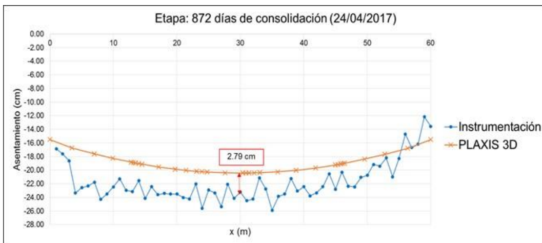
Fig. 4.1.9.59. Asentamiento a los 872 días del final del proceso constructivo
