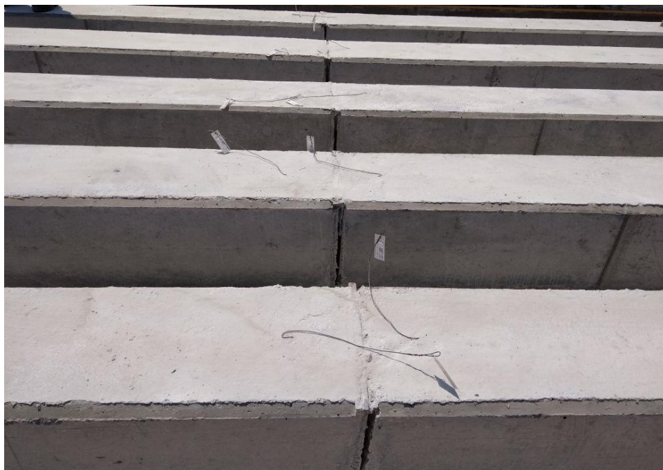
Fig. 4.9.2.2.3. Pilotes de fricción con fuste muy liso
