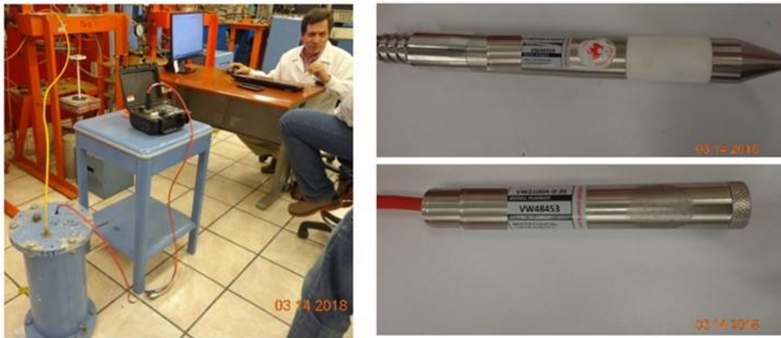
Fig. 4.1.11.4. Sistema de verificación y algunos piezómetros eléctricos para pista 6
