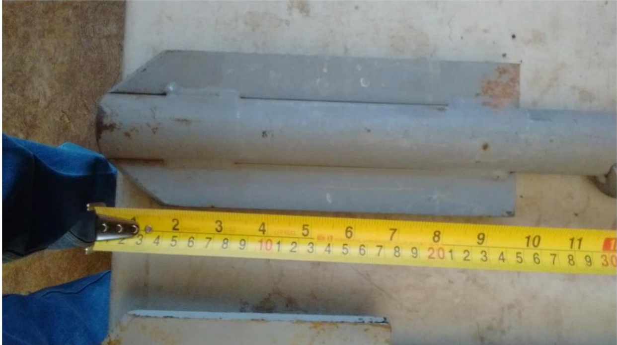
Figura 12 Aletas de reacción del tubo que queda atornillado al piezómetro
