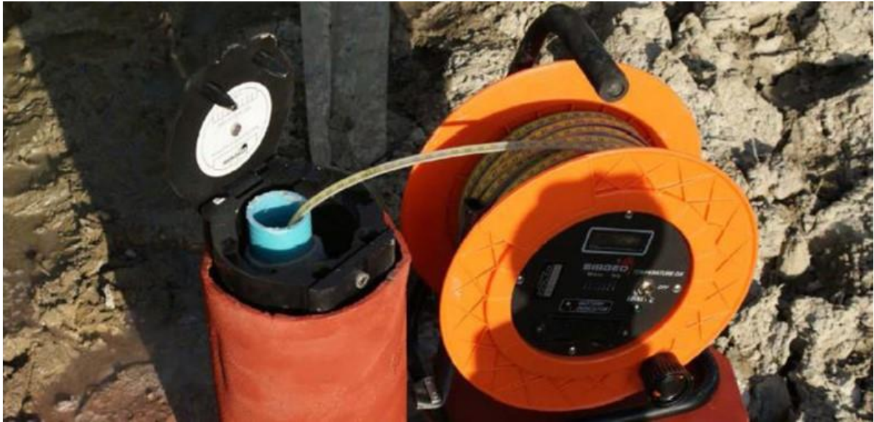
Figura 4. Sonda eléctrica para medir la profundidad del NAF.
