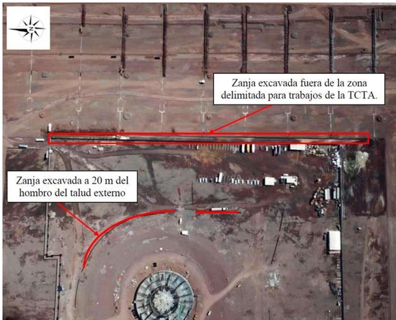
Figura 2. Vista en planta de las zanjas excavadas para captar el flujo proveniente del “reservorio relleno con tezontle” (CFE).
