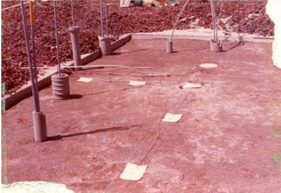
Figura 5.i.1.5 Ubicación de puntos de control topográficos, piezómetros y celdas de presión (Zarate, 2014).
