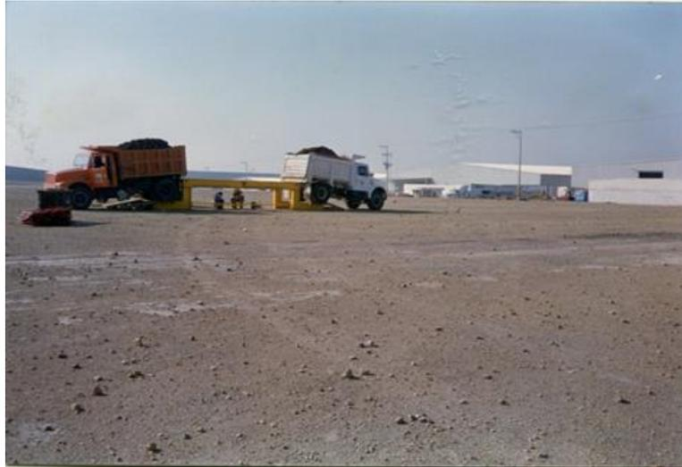
Figura 5.i.1.13 Ejecución de pruebas de placa (Zarate, 2014).
