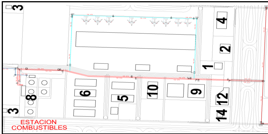
Figura II.69 Trayectoria de los ductos de 24" de suministro de turbinas a red de abastecimiento.
